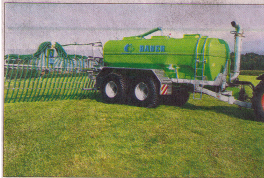
Das Poly-240-TRI Fass bringt je nach Grösse 15 bis 25% Gewichtersparnis und dadurch mehr Nutzlast.
